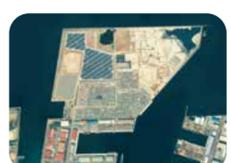
家庭から発生するゴミを焼却場で燃やした後の燃えかすや、工事現場で発生した土などを、海を埋め立てる材料として再利用するフェニックス計画が泉大津沖で行われています。完成した土地は、海外に輸出される中古車の保管場所や野外コンサートの会場などに利用されています。
